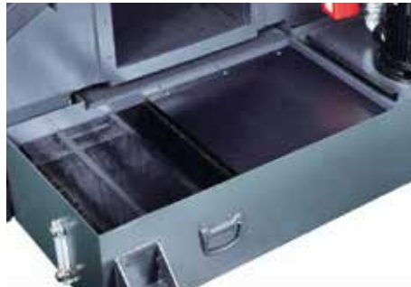
Vasca raccolta refrigerante con dispositivo di separazione parti solide e parti liquide.
