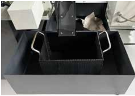
Convogliatore pezzi finiti programmabile dal controllo CNC.
